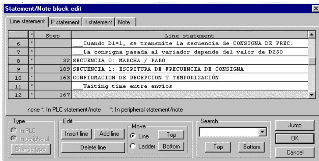
Si utilizamos los botones de la sección **Edit**, podemos insertar líneas nuevas entre la statement/note actual y la posición inmediatamente superior (**Insert line**) o añadir una nueva línea entre la posición del cursor y la línea inferior (**Add line**), también tenemos la posibilidad de borrar líneas (**Delete line**).
