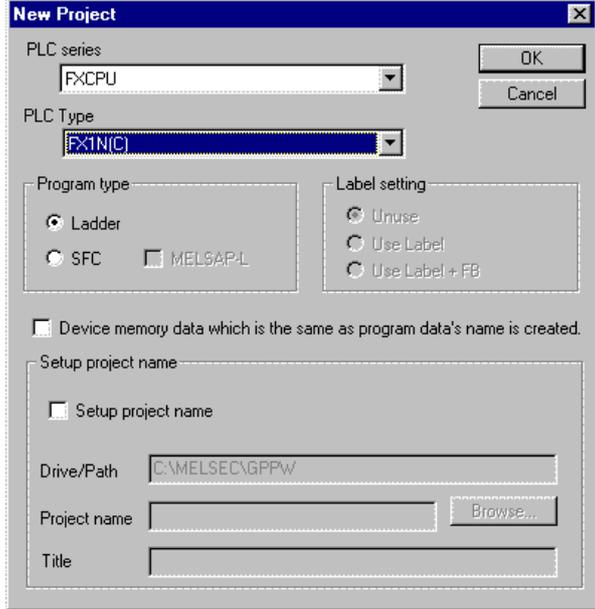
La opción 4 sirve para crear directamente un archivo de dispositivos, con el que iniciar los valores de las variables (datos D y marcas de bit M). Si no se selecciona, tenemos la posibilidad de activarlo durante la ejecución del proyecto.
