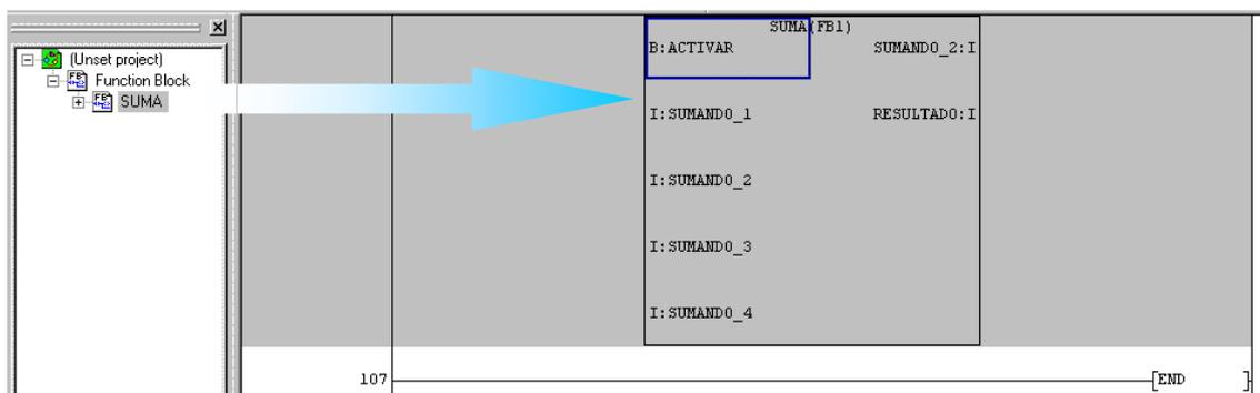
Seguidamente, se añaden las variables de entrada y salida al bloque de función. El código queda como se muestra en la siguiente figura:
