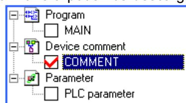
Utilizando la sección **Memory capacity** del **PLC Parameter** (desde el **Data project list**) podemos configurar la memoria de un autómeta de la serie FX. Por ejemplo, en un FX1N tenemos inicialmente 8000 pasos de programa, los cuales pueden ser recortados para añadir comentarios al proyecto y que éstos queden almacenados en el PLC.
