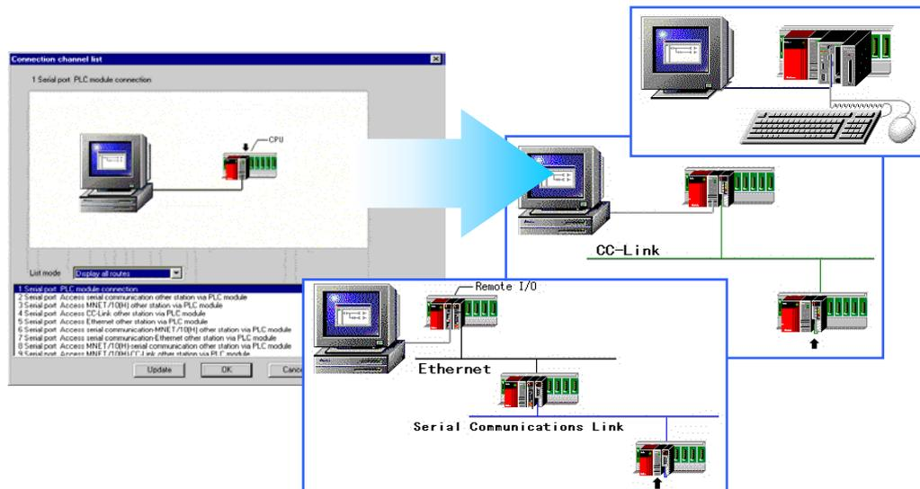
**PC Side I/F:** Aparecen todas las posibilidades de comunicación del software GX Developer según la serie de autómatas con la que se está trabajando. Por ejemplo, en la serie Q, podemos utilizar comunicación serie con RS-232 o puerto USB, red CC-Link o a través de Ethernet son algunas de las posibilidades que se nos ofrecen.
