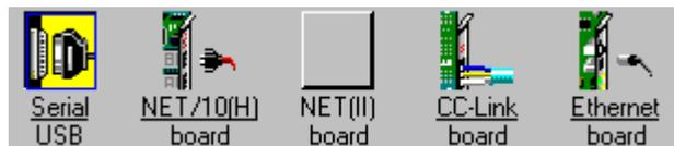
**PLC Side I/F:** En esta sección aparecen las opciones disponibles para el autómata que se utiliza en el proyecto. Hay que especificar si la conexión es directa al puerto de la CPU, o si se utiliza un módulo de comunicación serie (RS-232 o RS485/422), un módulo para red Ethernet, CC-Link, etc...
