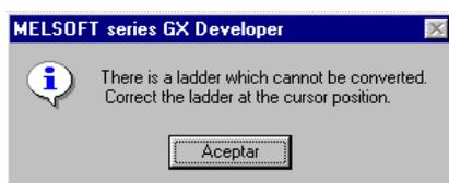
**ATENCIÓN:** Si se crea una línea de conexión con contactos/bobinas o instrucciones que no pueden ser convertidas correctamente se mostrará el siguiente mensaje de error y no convertirá nada.
