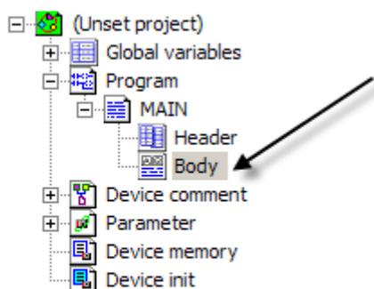
La introducción de las diferentes sentencias del programa se realiza mediante una pantalla de edición de texto. Durante la introducción de una variable o una sintaxis de control, el color del texto varía. Si no cambia, puede ser debido a un error de sintaxis o bien a una variable no definida.
